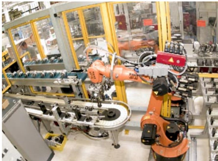
Die Achsmuttern sind der letzte Montageschritt, bevor die Komplett-nabe verpackt wird.
