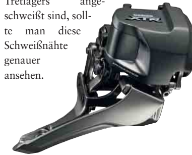
Hi-Tech ohne Kabelsalat. Das Spitzenmodell von Shimano, die Schaltkomponenten der Gruppe XTR Di2, werden über Funk vom Lenker gesteuert und arbeitet mit Elektromotoren.
